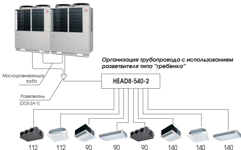
Разветвитель трубопровода наружных блоков
